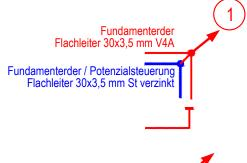
Ableitung Anschluss mit Edelstahl V4A bei Austritt in ein anderes Medium, in aufgehenden Bauteilen Rundleiter Rd 10 mm, sofern vollflächig vom Beton umschlossen Stahl, verzinkt, mit PVC-Isolierung ausreichend
