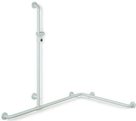
Brausehalter stufenlos verstellbar Senkrechte Länge 1100mm, Waagrechte Länge 1185mm und 762mm 90mm tief, Stangen ø 33mm HEWI
